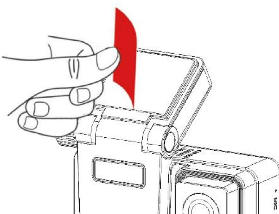
2. Присоедините блок регистратора к кронштейну, снимите защитную пленку с клеевой площадки кронштейна и прикрепите регистратор к лобовому стеклу за зеркалом заднего вида, в одной из зон как показано выше.
