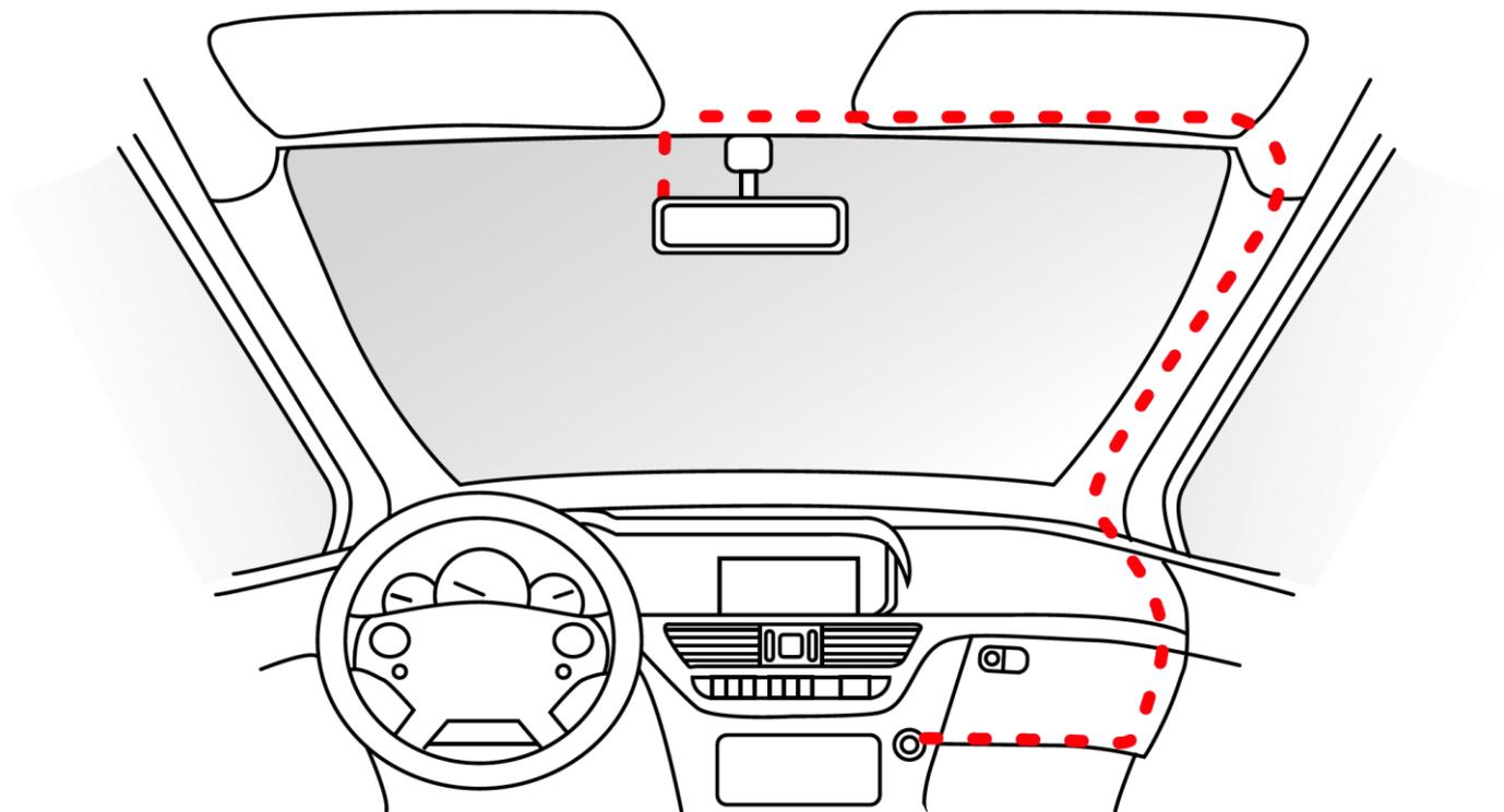
Подключите кабель питания к разъему microUSB, расположенному на корпусе кронштейна.
